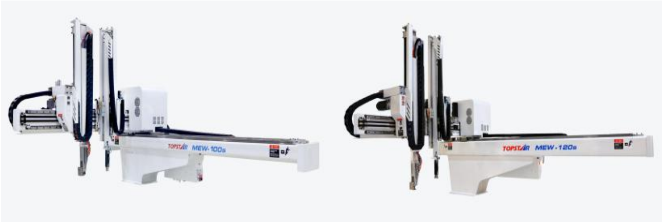
图2: XYZ三向伺服控制五轴机械手
